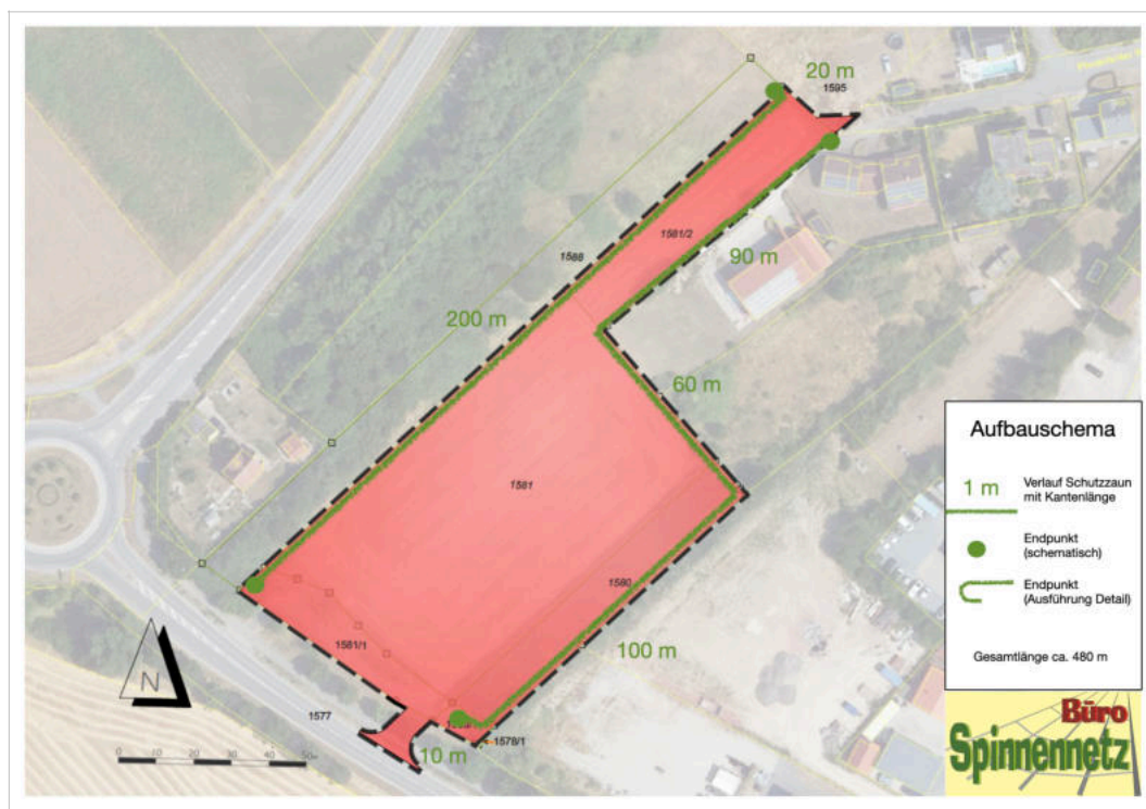
Abb. 2: Aufbauplan des Schutzzauns gegen einwandernde Reptilien
