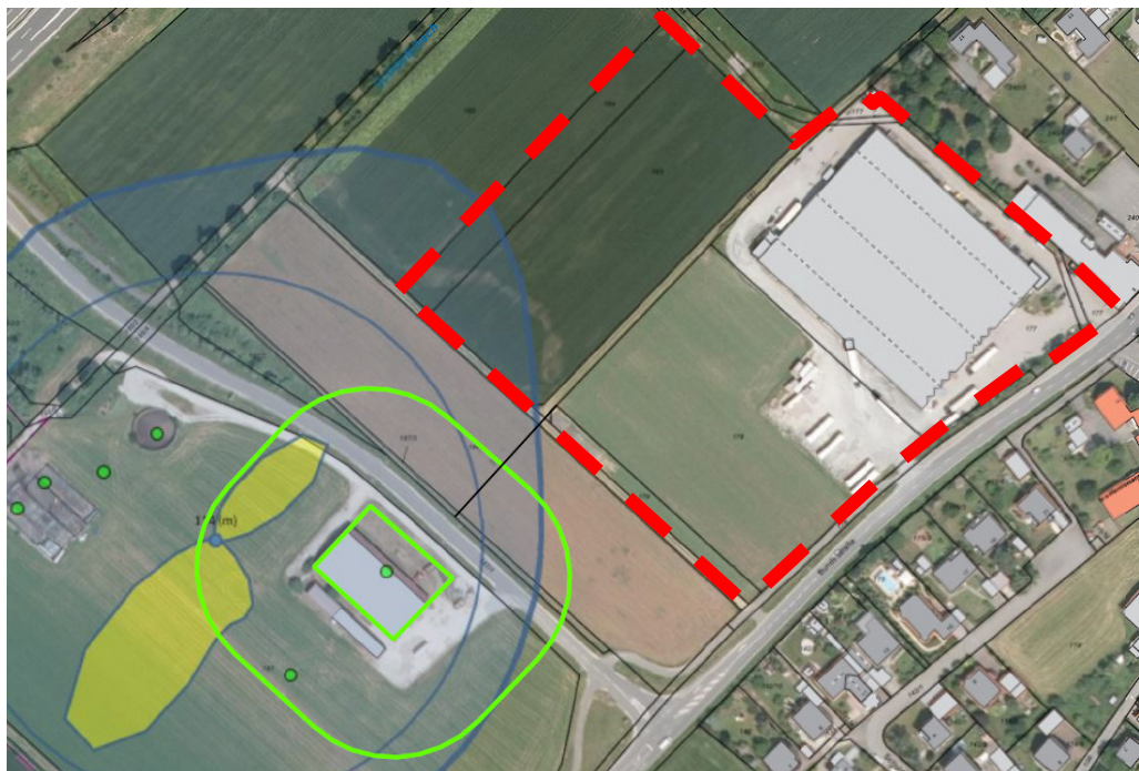
Abb. 9: Darstellung der Geruchsausbreitung im Umfeld des Aussiedlerhofes/ Milchviehstalles unter Annahme einer Verdoppelung der aktuell bestehenden Tierzahl und eines zusätzliche Stalles (Geltungsbereich mit rot gestrichelter Linie schematisch abgegrenzt, Darstellung genordet, ohne Maßstab (o. M.), Quelle: LRA Lichtenfels)
